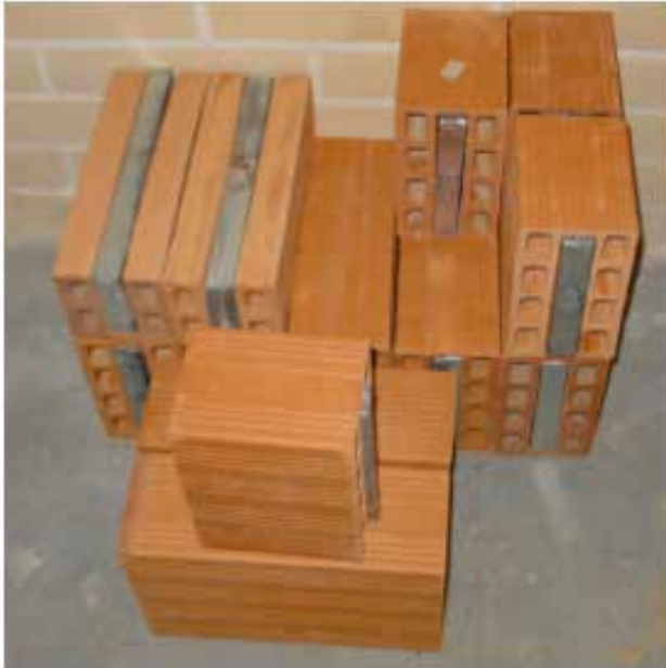
Figur 4.8. Integrerat PCM i byggmaterial [8].
